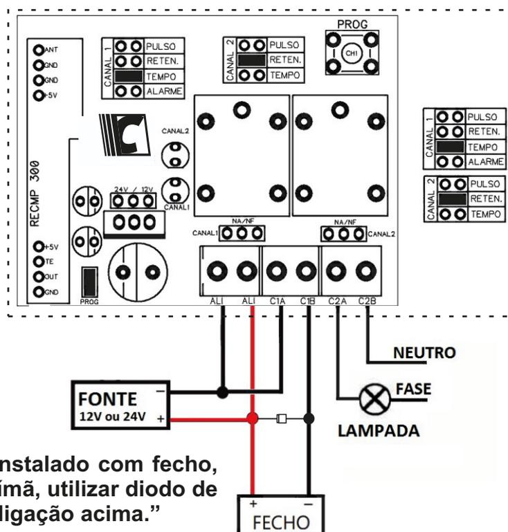
“OBS.: quando for instalado com fecho, fechadura ou eletroímã, utilizar diodo de proteção conforme ligação acima.”
